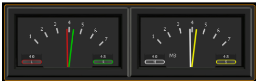
Beispiel: PPM-Anzeige im Dual-L/R-Modus links neben Dual-M/S-Modus bei horizontaler Ausrichtung des TM3
